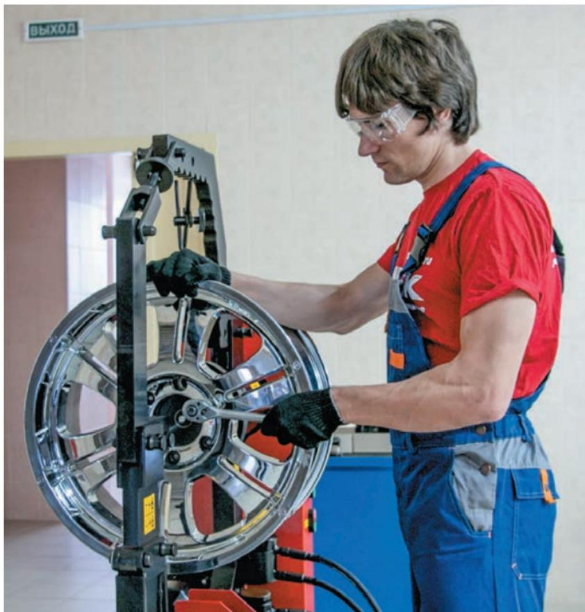
**Закрепите диск болтами, используя все крепежные отверстия, а также установите стяжку между стойкой и упором.**
