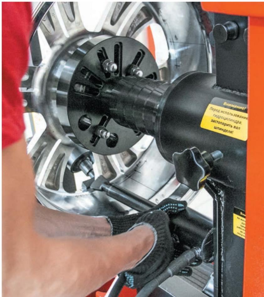
При правке спицы используйте второй гидроцилиндр как вспомогательный с противоположной стороны.
