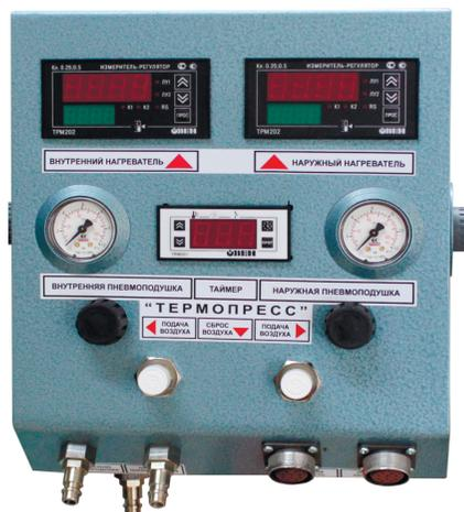
Светодиоды "I" и "II" на измерителях-регуляторах сигнализируют о выводе на индикацию температуры соответствующего канала данного гибкого нагревателя. Светодиоды "K1" и "K2" сигнализируют о включении регулятора в режим нагрева соответствующего канала данного гибкого нагревателя. Таймер самопроизвольно включен в режим (t°), не используемый в нашем случае. Для перевода таймера в режим "Время" нажмите кнопку . (При этом гаснет светодиод (C) и загорается светодиод под символом ).
